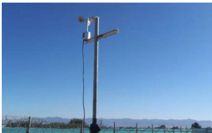
Figuur 7. Anemometer geïnstalleerd naast het bassin op een hoogte van 2 m.
