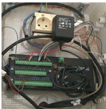
Figuur 8. Opnamebox met de datalogger (CR1000, Campbell SCI).
